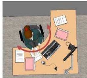
Plan symétrique : plusieurs zones de travail accessibles par rotation (contraintes posturales), agent de biais face à l'écran ou aux documents
